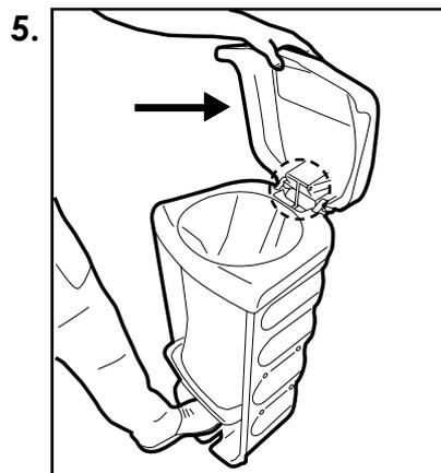
Sin retirar el pie del pedal, empuje la tapa hacia atrás para que encaje en el receso.
